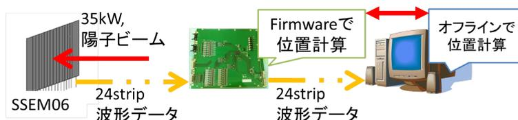
図 103 動作試験の概略図
