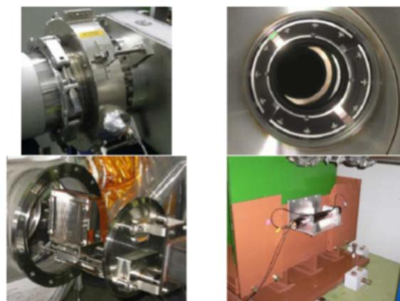
図 10 Primary Beam line 上のビームモニターの写真 [23]。左上図が CT で、右上図が ESM で、左下図が SSEM で右下図が BLM
