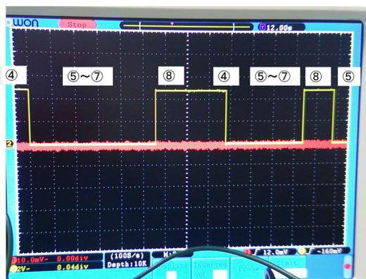
図 102 オシロスコープで取得した Interlock 信号の動作結果。図中の数字は実験手順の番号を示している。
