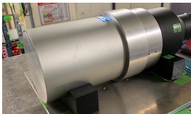
図 3.12: 有機液体シンチレータ BC-501A(20LA32) [41]
