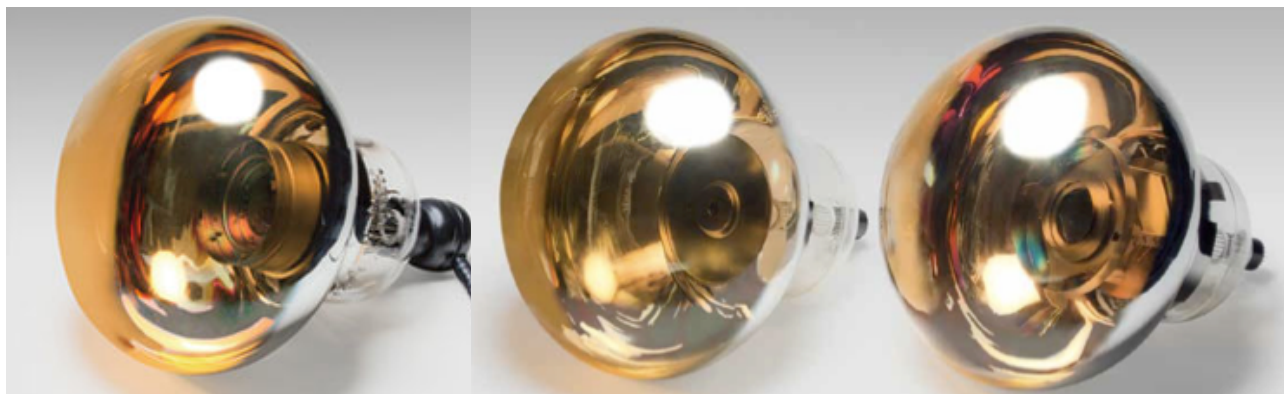
図 3.1: スーパーカミオカンデで使われている R3600 (左) と新規開発されている 50 cm Hybrid Photo Detector(中央) 及び 50 cm Box & Line PMT(右)。外形は似ているがダイノード構造 (HPD ではアパランシェダイオード) や光電面の曲率がそれぞれ違っている。
