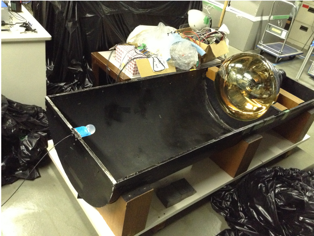
図 4.3: 相対収集効率測定の写真。円柱状の箱がミュメタルで覆われている暗箱。左に見える白い球がデフューザーボール、PMT までの距離を 103 cm とした。
