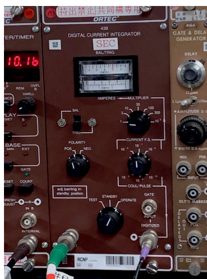
図 2.5 RCNP で使用されている ORTEC 社製のカレントインテグレータ Model 439
