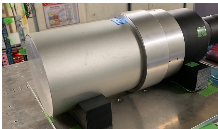
図 2.8 Saint-Gobain 社製 有機液体シンチレータ BC-501A (20LA32)。ビーム軸上に配置し、中性子フラックスを測定する。
