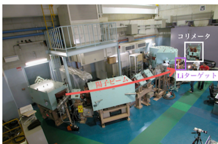
図2.2 陽子ビームガイド用の磁石とコリメータの配置。写真手前に見える磁石で陽子ビームを曲げ、Liターゲットまでガイドする。 {}^7\text{Li}(p, n){}^7\text{Be} 反応で生成された中性子やガンマ線は写真奥のコリメータに向かって飛んでいく。大阪大学核物理研究センターホームページより引用
