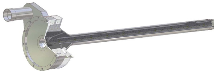
図5 T2K 実験で用いられるターゲット概略図 [7]
