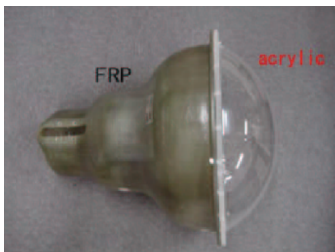
図 16 20-inch PMT の衝撃波防止ケースの外観。
