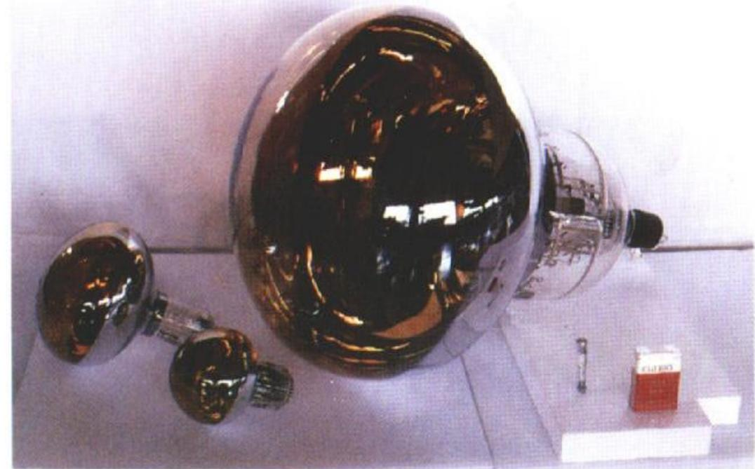
3000トン水タンク、約1000本の光電子増倍管
