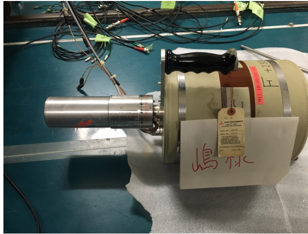
図 4.3.11 E465 実験で使用した Ge 半導体検出器 ORTEC 社製 GEM 20180-P
