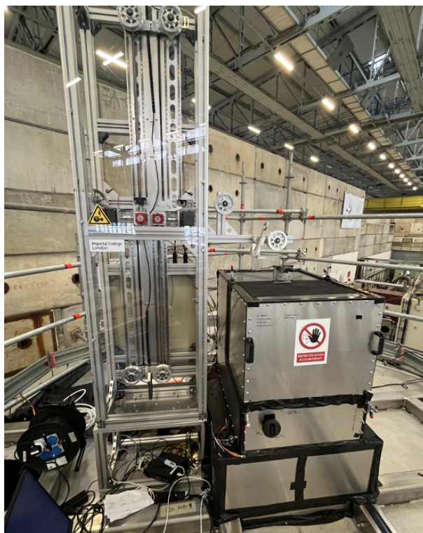
図 5.16: CDS の外観。検出器の屋上に設置されている。
