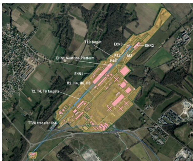
図 32: North Area を上空から見た図. 2 つの地上実験施設の広さは, EHN1 が 330 \times 50 \text{ m}^2 , EHN2 が 110 \times 30 \text{ m}^2 であり, 地下施設である ECN3 は幅 16 m, 長さおよそ 100 m の空洞である. NA61/SHINE の実験ホールは EHN1 にある [51] .
