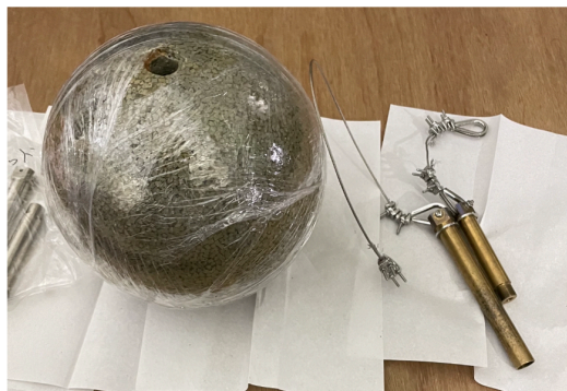
図 4.1: Ni ボール (左) と Cf 線源を固定する真鍮製のロッド (右)
